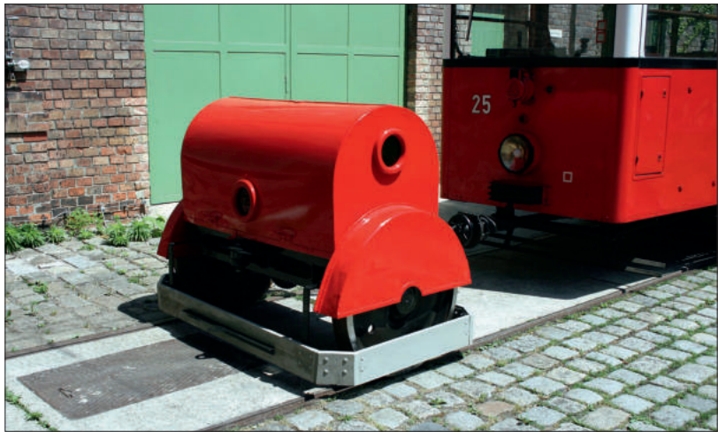
Die mechanische Messachse 7030.
