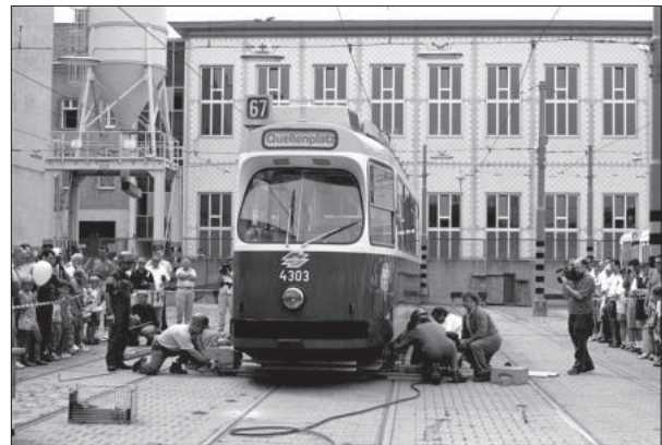
Leistungsschau im Bhf Favoriten - M 4082 auf einem Achsbruchwagerl (links) und Eingleisen des E 2 -Triebwagens 4303 (rechts). Fotos: Ernst Lassbacher, 19.7.1997
